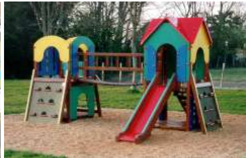
Référence 99 04 56 Age des enfants 3 ans et plus Nombre d'enfants 15 Dimensions du jeu (LxlxH) 430x377x245 cm Hauteur de chute 98 cm Zone d'évolution (LxlxH) 730x727x298 cm Surface de réception (Lxl) 730x727 cm Exemple de sols de réception autorisés sable, gravier, caoutchouc, gazon, ...
