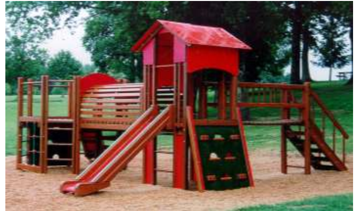
Référence 95 05 16 Age des enfants 3 ans et plus Nombre d'enfants 25 Dimensions du jeu (LxlxH) 629x565x260 cm Hauteur de chute 98 cm Zone d'évolution (LxlxH) 993x915x298 cm Surface de réception (Lxl) 993x915 cm Exemple de sols de réception autorisés sable, gravier, caoutchouc, gazon, ...
