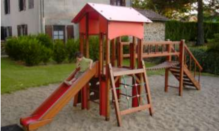
Référence 96 03 31 Age des enfants 3 ans et plus Nombre d'enfants 12 Dimensions du jeu (LxlxH) 565x176x260 cm Hauteur de chute 98 cm Zone d'évolution (LxlxH) 915x476x298 cm Surface de réception (Lxl) 915x476 cm Exemple de sols de réception autorisés sable, gravier, caoutchouc, gazon, ...
