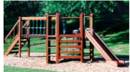
Référence 96 06 21 Age des enfants 3 ans et plus Nombre d'enfants 15 Dimensions du jeu (LxlxH) 662x203x175 cm Hauteur de chute 98 cm Zone d'évolution (LxlxH) 1012x503x298 cm Surface de réception (Lxl) 1012x503 cm Exemple de sols de réception autorisés sable, gravier, caoutchouc, gazon, ...
