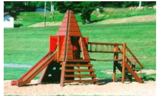
Référence 96 06 81 Age des enfants 3 ans et plus Nombre d'enfants 15 Dimensions du jeu (LxlxH) 600x165x285 cm Hauteur de chute 98 cm Zone d'évolution (LxlxH) 950x465x298 cm Surface de réception (Lxl) 950x465 cm Exemple de sols de réception autorisés sable, gravier, caoutchouc, gazon, ...
